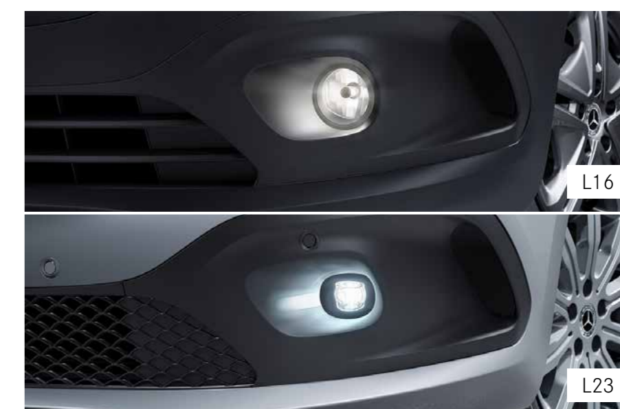
Phares antibrouillard halogènes (L16) Phares antibrouillard à technique LED (L23)(selon la finition)
