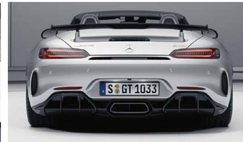
▲ Système d'échappement AMG Performance avec silencieux en titane
