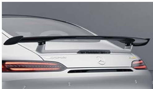
▲ Spoiler arrière fixe ajustable manuellement
