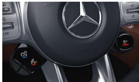
▲ DRIVE UNIT AMG avec touches au volant
