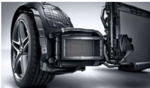
▲ Système de refroidissement AMG
