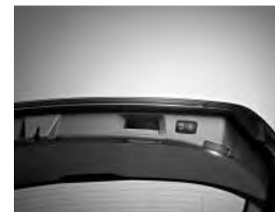
▲ Hayon EASY PACK à ouverture/fermeture automatique
