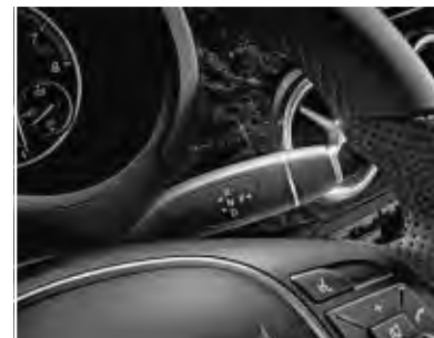
▲ Boîte automatique 7G-DCT avec levier sélecteur DIRECT SELECT
