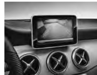
▲ Caméra de recul avec lignes de guidage
