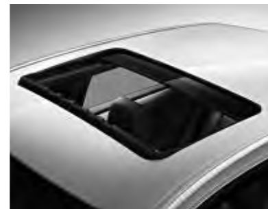
▲ Toit ouvrant relevable électrique vitré
