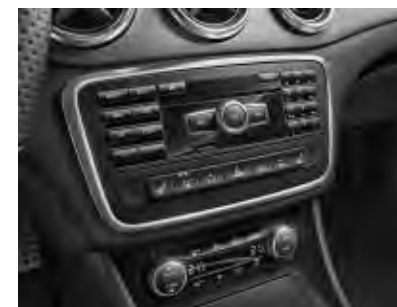
▲ Commande pour chauffage autonome (228)
