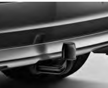
Attelage : dispositif de remorque ▲ à boule amovible
